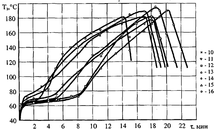
Рис. 6.15. Температурный режим при обжаривании ячменя обрушенного
